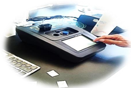
Figure 37 :photo personnel « Spectrophotomètre pour analyse des eaux »
