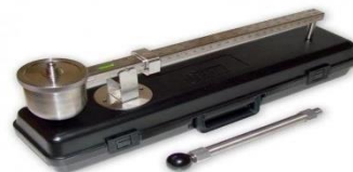
Figure I.16 Densimètre pressurisé FANN – Model 141
