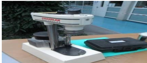
Figure I.18 Rhéomètre atmosphérique Chandler – Model 3530
