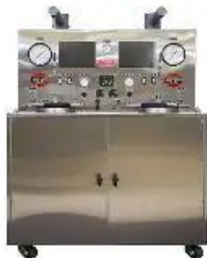
Figure III.33 Panel électrique du consistomètre 8040D1
