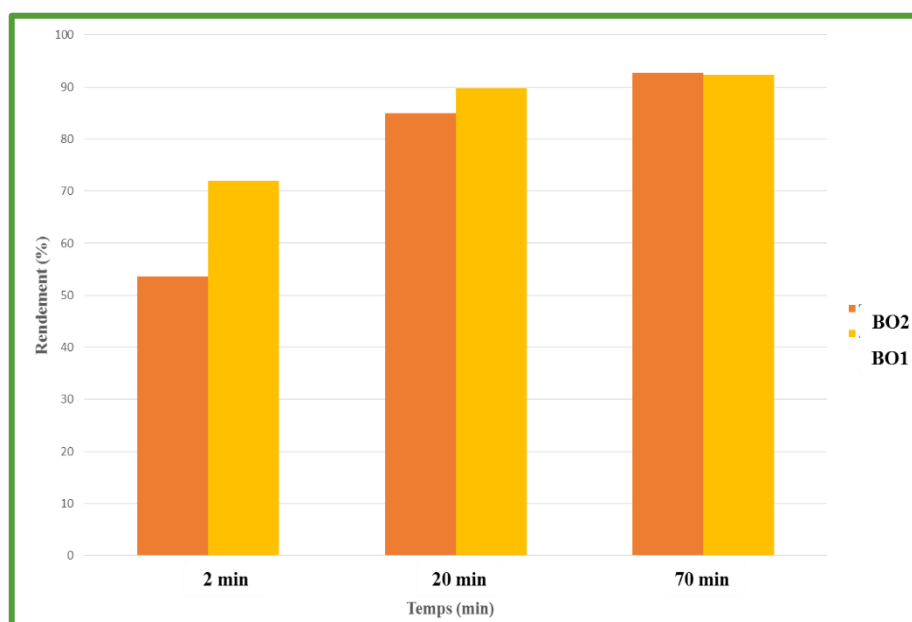
Figure III. 5 : Effet de la taille des particules du biomatériau étudié sur l'élimination du MV ( V = 200 ml ; C = 10 ppm ; v = 230 tr.min -1 ; pH = pH_{libre} ; T = \pm 21^{\circ}C ).
