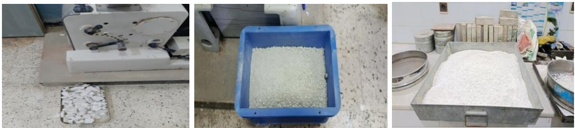
Image 3-5: Sable de déchet de plâtre
