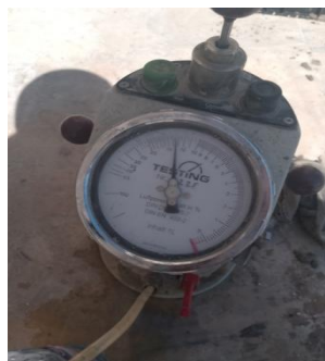
Image 4-6: Mesure de l' air occlus .
