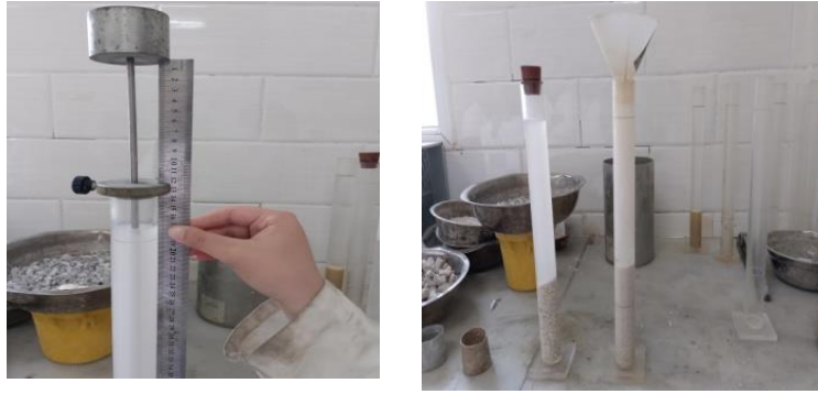
Image3-12: Essai équivalents de sables.
