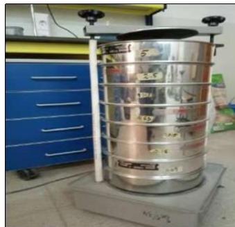
Image3-13: Essai analyse granulométrique.
