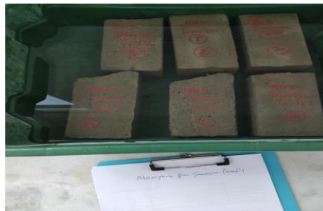
Image 4.8 : Essai d'absorption par immersion.
