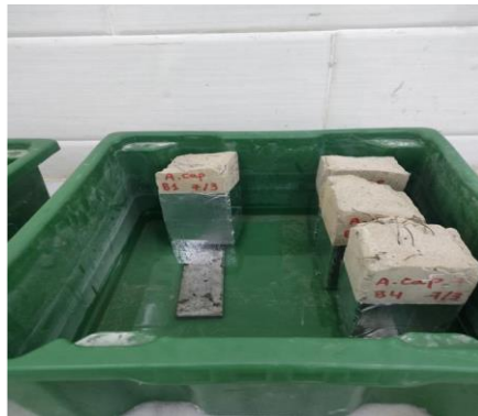
Image 4.9 : Essai absorption par capillarité .
