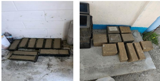
Image 4-2: Eprouvettes avant et après le démoulage .
