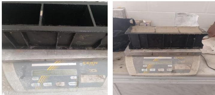
Image 4-5: Essai de la densité frais.
