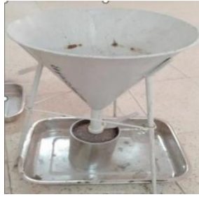
Image3.10: Essai Masse volumique apparente.
