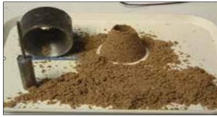
Image 3-11 :Essai Coefficient d'absorption de sable.
