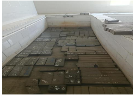
Image4-3: Conservation des éprouvettes dans un bain d'eau.
