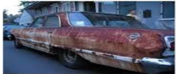
Figure I.1 : Corrosion généralisée : exemple d'une porte et d'un véhicule corrodés.
