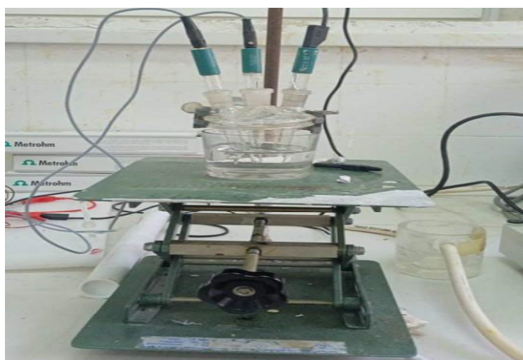
Figure III.13 : Cellule électrochimique à trois électrodes.
