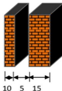
Fig II.10-Détail des constituants d'un mur extérieur
