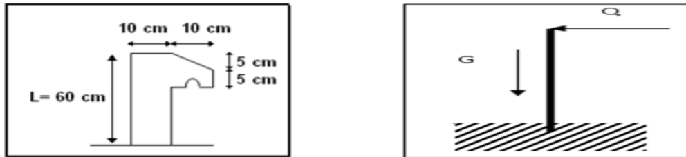
Fig III.12- Schéma statique de l'acrotère
