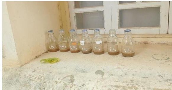
Figure 23 : Effervescence du sol après ajout d'eau oxygéné
