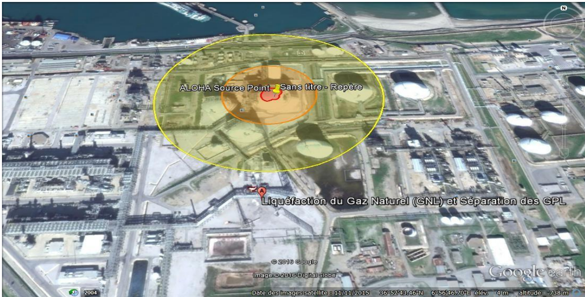
Figure III.15 : Cartographie des zones menacées par les effets thermiques d'une explosion.
