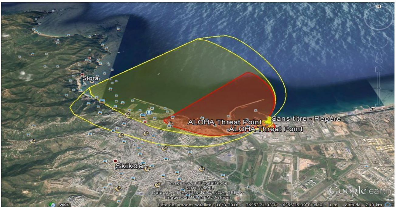
Figure III.18 : Cartographie des zones menacées par les effets sur pressions zone nuages de vapeur inflammable.
