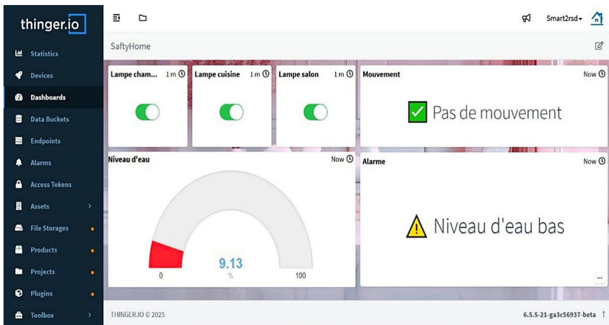
Figure 4.50 : Tableau de bord dans le cas ou le niveau d'eau inférieur à 25%.
