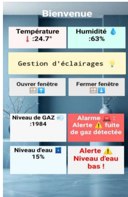
Figure 4.55 : Alerte dans le cas où une fuite de gaz détectée et le niveau d'eau bas
