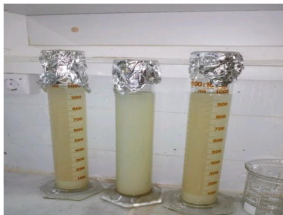
Figure IV.11: séparation de phase dans l'étape de purification.
