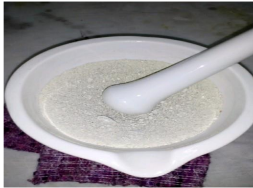
Figure IV.7: Broyage de l'argile.
