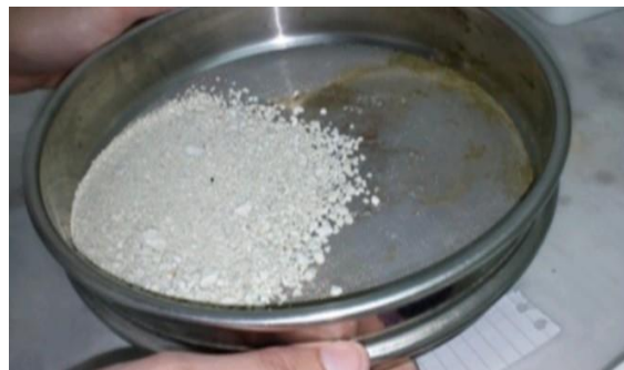
Figure IV.8: Tamisage de l'argile
