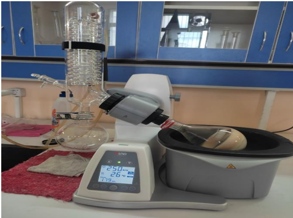
Figure III.11 : Photo du montage de l'impregnation (rote à vapeur).
