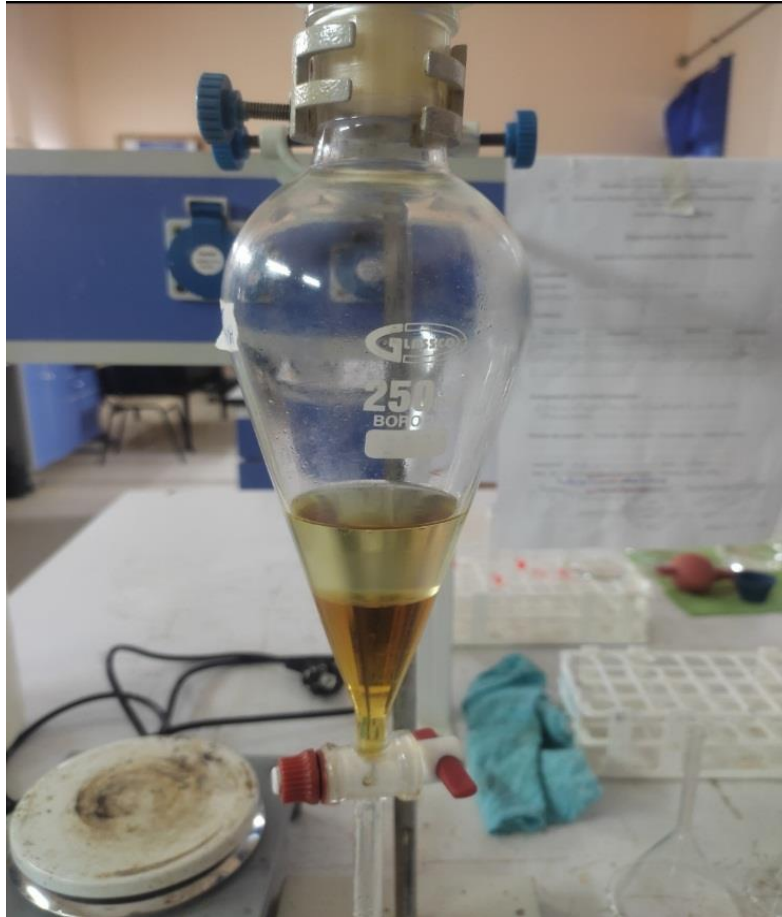
Figure III.16 : Photo de décantation après 24 heures.
