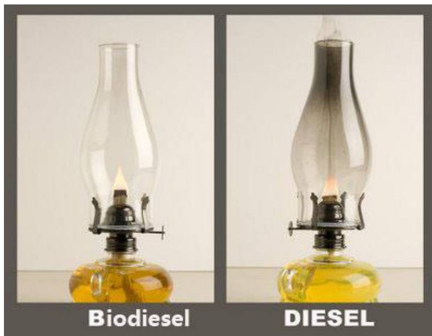
Figure II.2 : Comparaison entre la combustion incomplète de diesel et la combustion complète de biodiesel.
