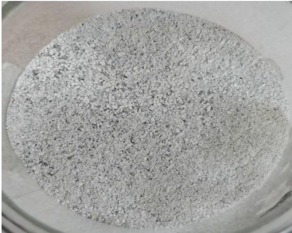
Figure III.9 : Photo des coquilles d'œufs après calcination.
