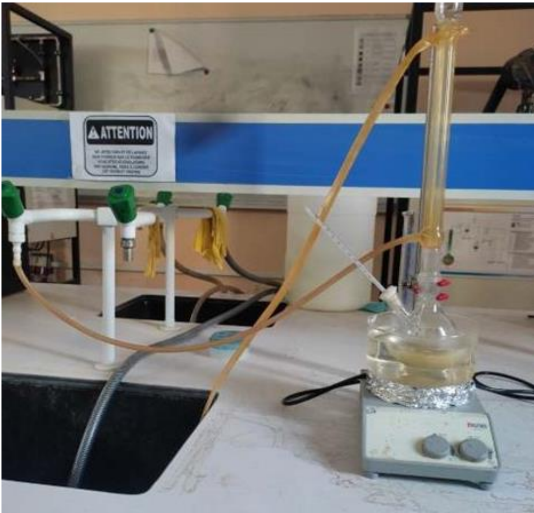
Figure III.3 : Photo du montage de la réaction de transestérification.
