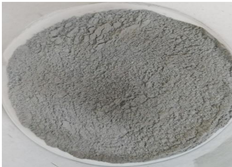
Figure III.13 : Photo des coquilles d'œufs imprégnées après calcination.
