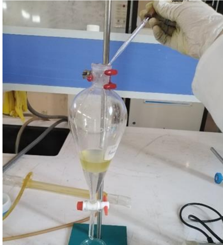
Figure III.5 : Photo du lavage du biodiesel.
