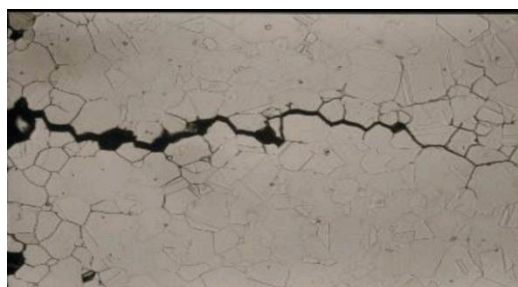
Figure I.3.1.8. Corrosion sous contrainte [58]
