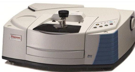
Fig. III.8 : Spectromètre à Transformée de Fourier de type NICOLET iS10 de marque thermo scientifique (LRPCSI).
