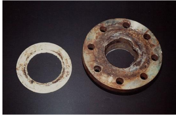
Figure I.7 : Aspect et mécanisme d'attaque de la corrosion caverneuse.
