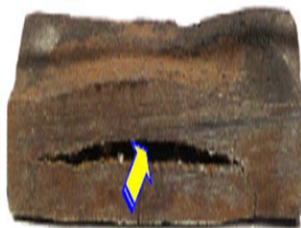
Figure I.14 : La fragilisation par hydrogène d'une pièce métallique
