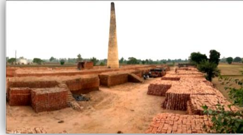
Figure 1 11: Chambre de cuisson pour la fabrication de briques, b) Four de la cuisson des briques cuites (Chanda, 2016; Akhtar & al, 2022).
