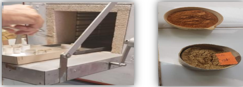
Figure 4 21: Essai de la teneur en matières organiques, cliché auteur.
