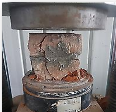
Figure 3 61: Essai de compression uni-axiale sur une brique ancienne de Skikda.
