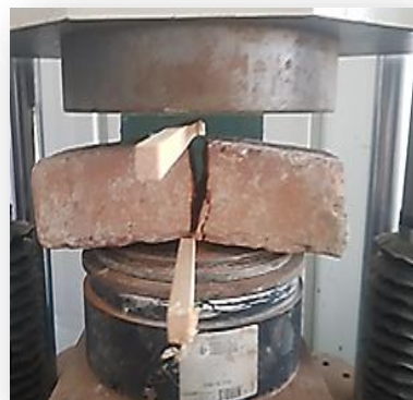
Figure 3 62: Essai de traction indirecte sur une brique ancienne de Skikda.
