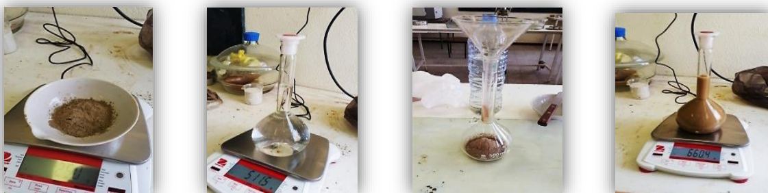
Figure 4 28: La mesure de la densité apparente au pycnomètre.
