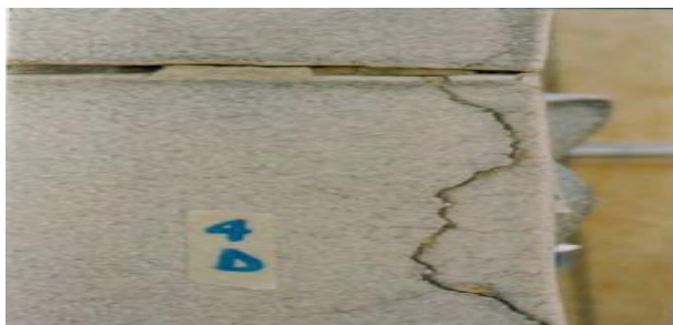
Figure 2 9: Des céramiques fissurées suite à des mouvements structurels provenant de l'intérieur de l'artefact (Fabbri, 2012).
