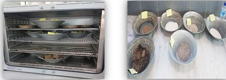
Figure 4 29: La mesure des teneurs en eau.
