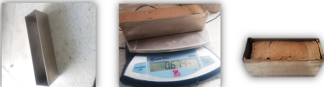
Figure 4 30: Le principe de l'essai de retrait simplifié.
