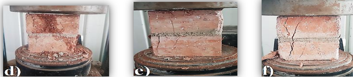
Figure 5 9: Essai de compression uni-axiale sur des échantillons représentatifs : (a) SOFB; (b) CMB; (c) WSB; (d) SFB; (e) VFMPB; (f) FMPB.
