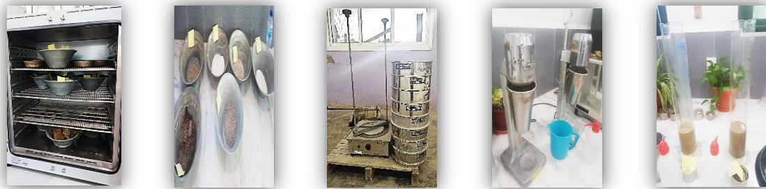
Figure 4 32: L'essai de la granulométrie par tamisage et par sédimentométrie.
