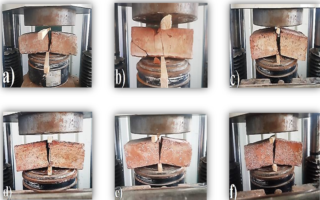
Figure 5 10: Essai de traction indirecte sur un échantillon représentatif : a) a) SOFB; b) CMB; c) WSB; d) SFB; e) VFMPB; f) FMPB.
