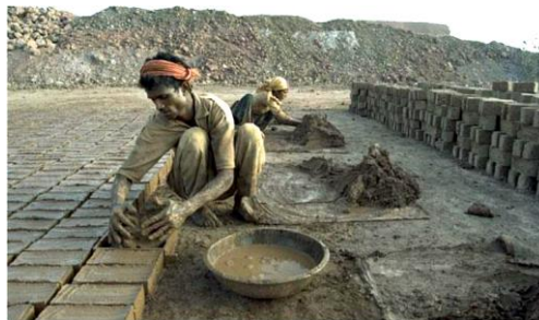
Figure 1 10: Moulage dans le processus de fabrication de briques (Chanda, 2016).
