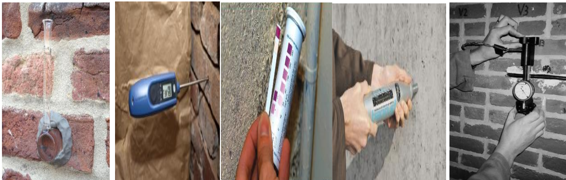
Figure 2 13: Quelques outils de teste non destructifs : a) La pipette de Karsten, b) D'un humidimètre, c) Des bandelettes indicatrices de sels, d) Le scléromètre, e) un vérin plat (Toolkit, 2021).
