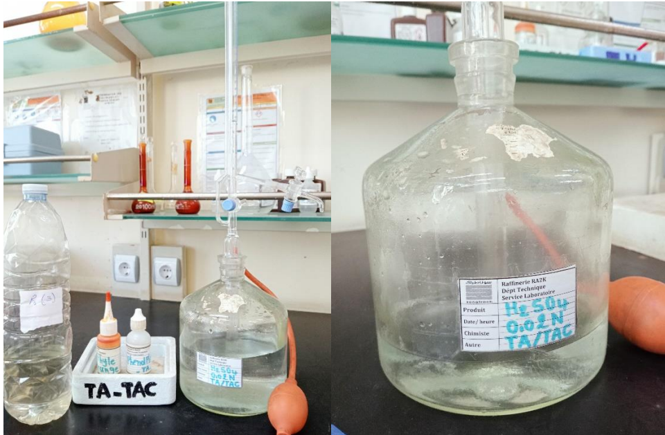
Figure IV.9. Titrage volumétrique de TA, TAC.
