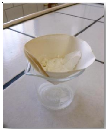
Figure 31: Filtration du produit.
