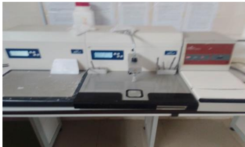
Fig.32 : Réalisation des moules dans le console à l'aide de paraffine.
