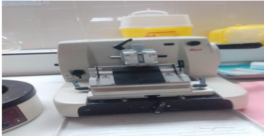
Fig.33 : Réalisation des coupes histologiques très fine à l'aide d'un microtome.
