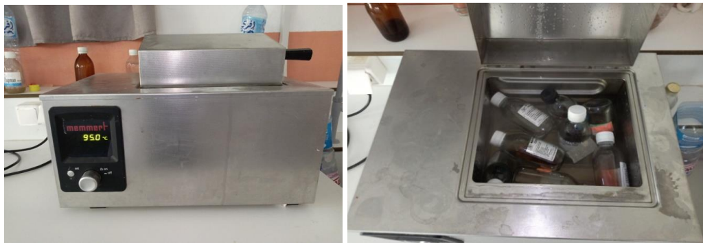
Fig.11 : Bain marie pour transformer les milieux de culture de l'état solide vers l'état liquide.
