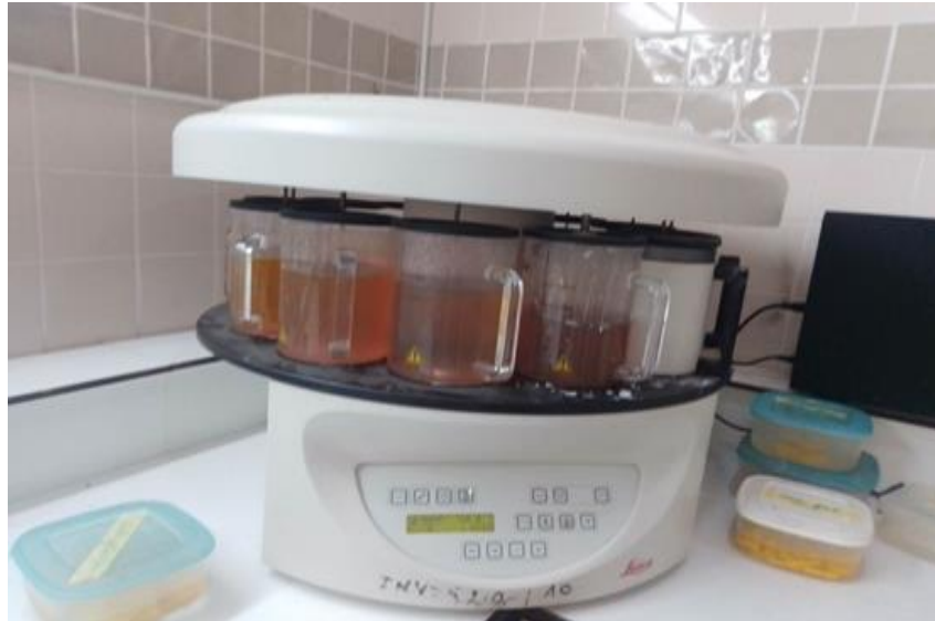
Fig.31 : Dépôt des échantillons dans un automate de l'histologie pendant 16 heures.
