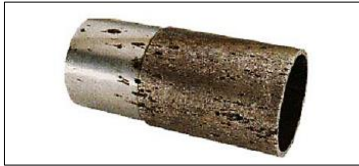
Figure I.11 : Corrosion par piqûres d'un acier inoxydable [25].
