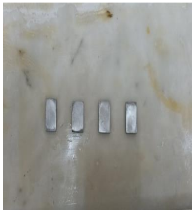
Figures III.9 : Polissage des pièces métalliques.
