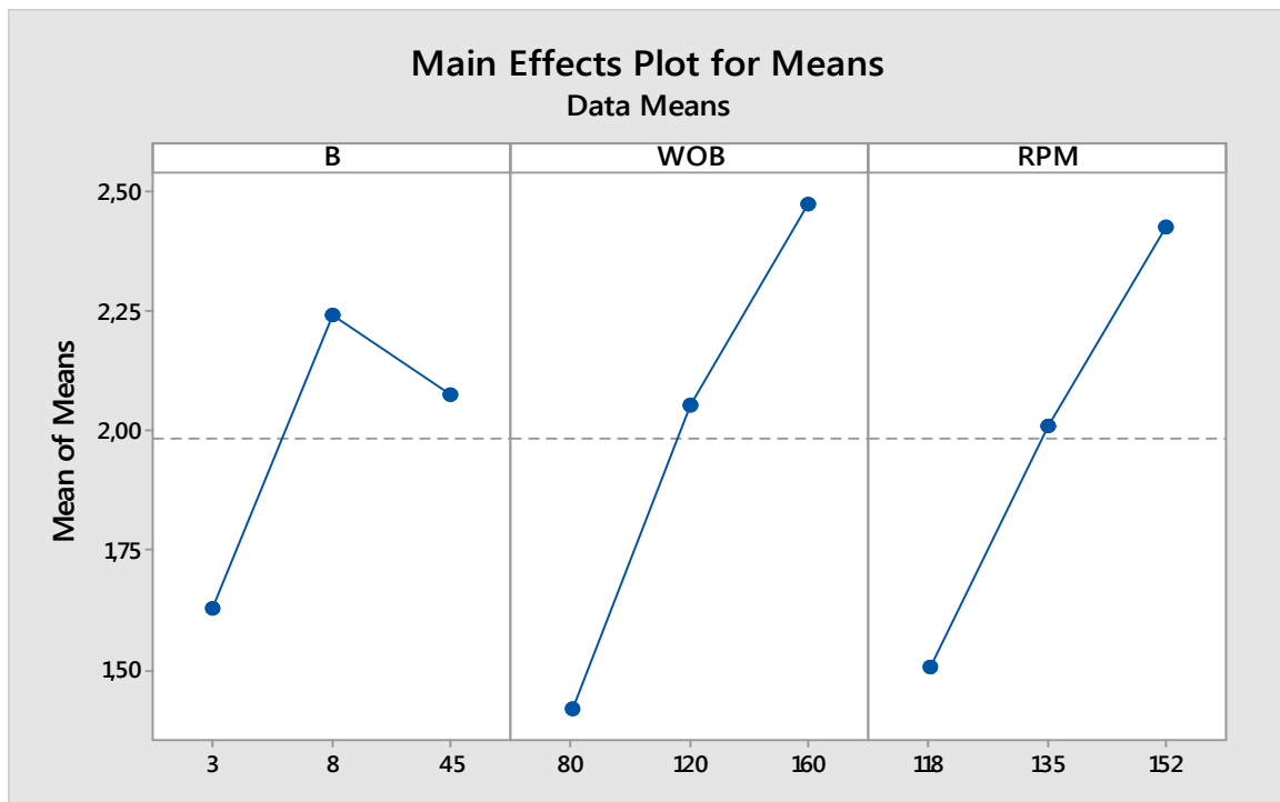
Figure 6.6: Principaux effets sur le taux de pénétration ROP (pour la roche C).
