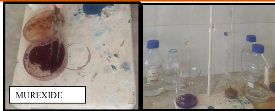
Figure 33 : Photographie du Dosage du calcium ( \text{Ca}^{2+} ) et magnésium ( \text{Mg}^{2+} ). (Photos originales, 2025)
