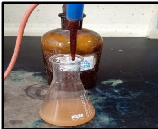
Figure 34 : Photographie du Dosage du chlorure ( \text{Cl}^- ) (photos originales, 2025)
