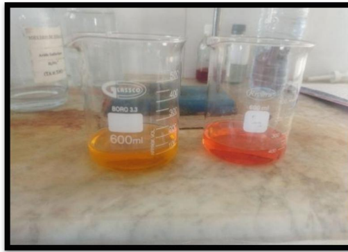
Figure 32 : Photographie du Dosage (TA)/(TAC). (Photos originales, 2025)
