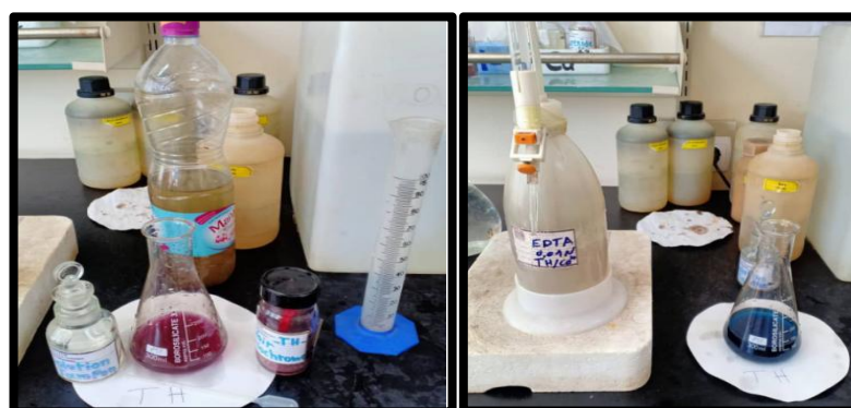
Figure 31 : Photographie du Dosage (TH) (Photos originales, 2025)
