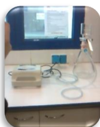
13) Ensemble de Filtration des eaux
