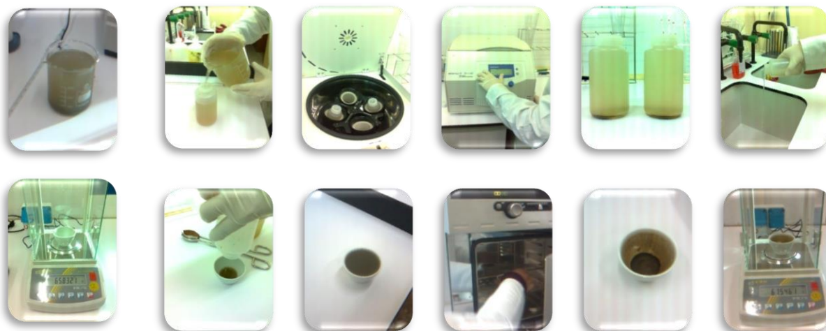
Figure N°22 : Détermination de la MES des eaux brutes par centrifugation.
