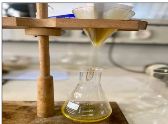
Figure VII.1 : Filtration d'un échantillon d'huile de cuisson usée (WCO) à l'aide d'un papier filtre.
