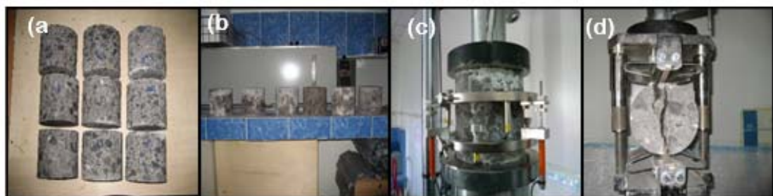
Figure II- 33: Essais au laboratoire sur carotte (couche de fondation)
