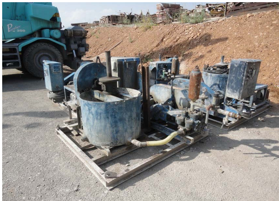
Figure V- 4: Pompe type MG-10 employée pour les travaux d'injection
