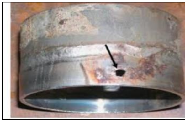
Figure .I.3 : Corrosion localisée [9]
