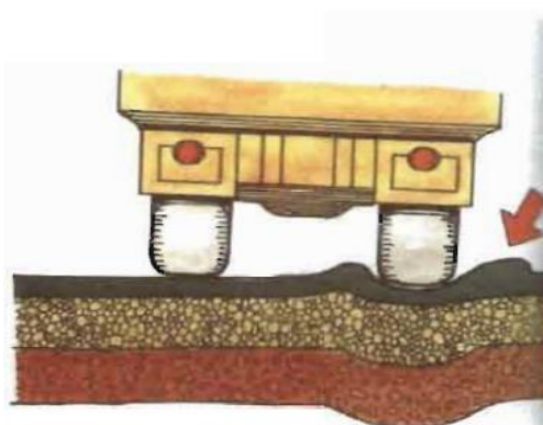
Figure 32 : Schématisation d'un bourrelet
