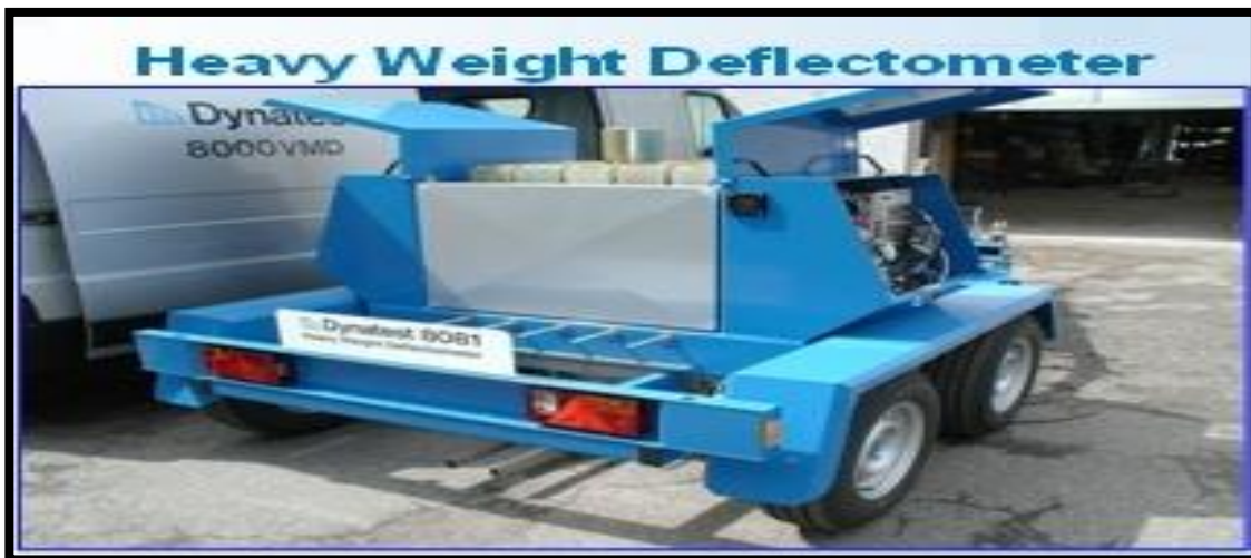
Figure 51 : Le défléctomètre à masse tombante
