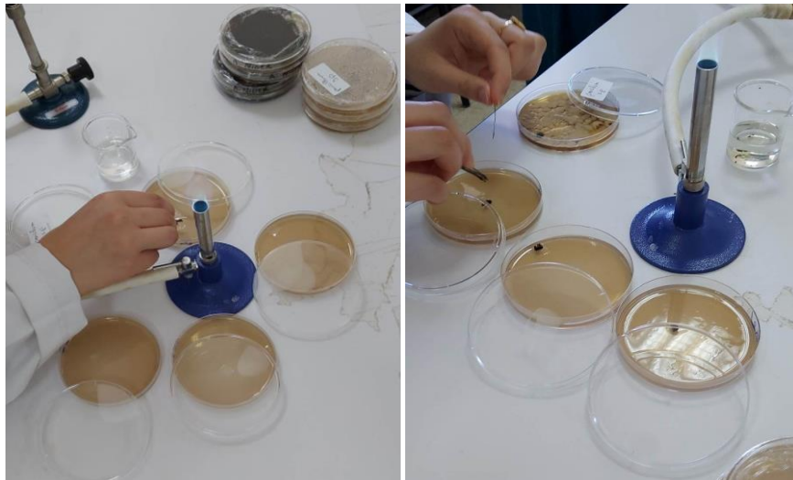
Figure III.13. Le milieu Bold Basal dans les boites de pétri avec le morceau de PET.
