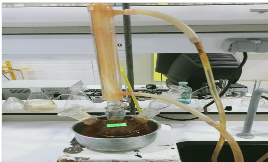
Figure III.5 : Montage représentant l'étape de mûrissement au laboratoire.
