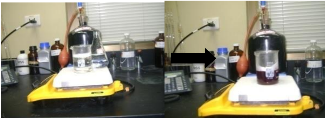
Figure III.8: Changement de la couleur après titrage par \text{KMnO}_4 .
