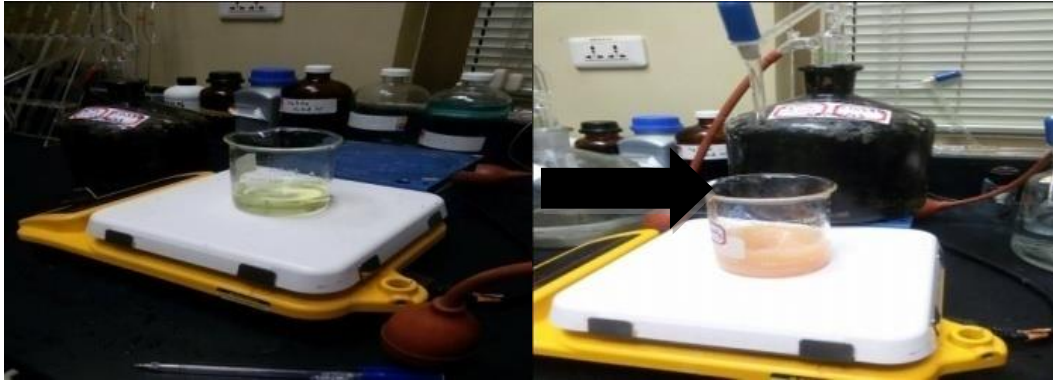
Figure III.9: Changement de la couleur des chlorures après titrage.
