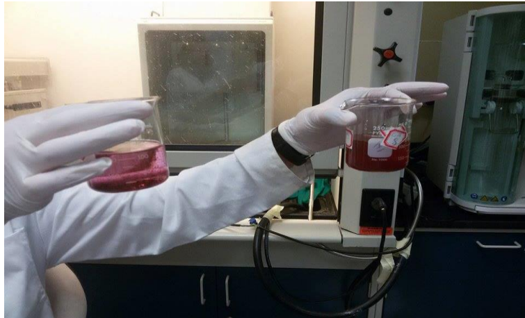
Figure III.10 : Changement de la couleur pour la détermination de la matière organique.
