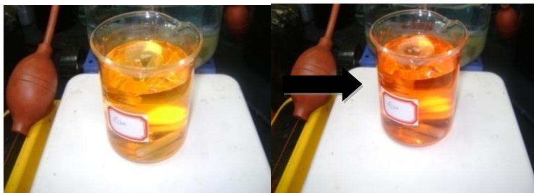
Figure III.5 : Changement de la couleur d'échantillon après le titrage par H_2SO_4 .
