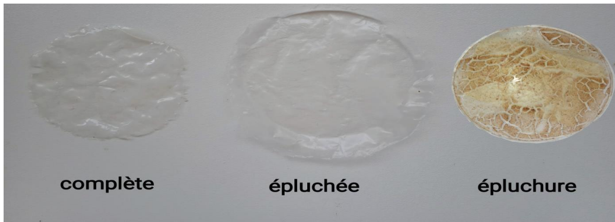
Figure 34 : photo du film de bioplastique de pomme de terre Atlas
