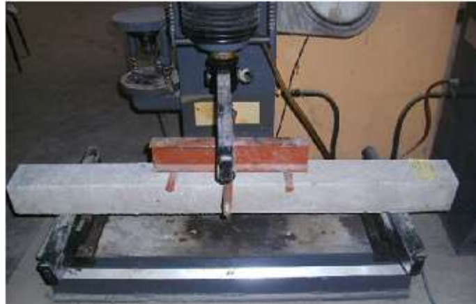
Photo IV. 2: Mesures de la charge de rupture.
