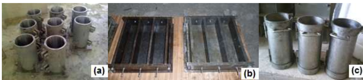
Photo III. 3 : Les éprouvettes utilisées (a) Cylindriques 10x20cm (b) prismatiques 7x7x28cm (c) Cylindriques 16x32cm
