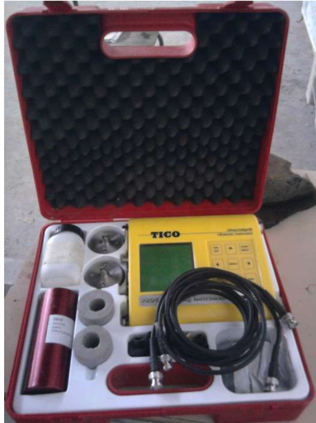
Photo V. 2: L'appareil utilisé pour la détermination de la fréquence de résonance.
