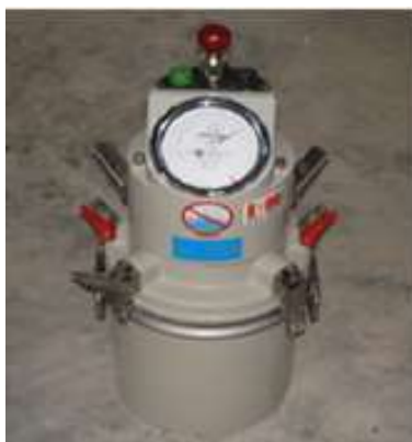
Photo III. 5: Aéromètre à béton.
