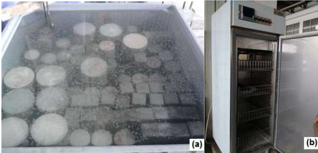
Photo V. 1: (a) Conservation des éprouvettes avant le test du gel-dégel (b) L'enceinte climatique.
