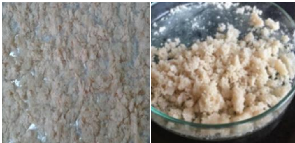
Figure II.1 : Carapace de crevettes après prétraitement et chitosane après deacétylation
