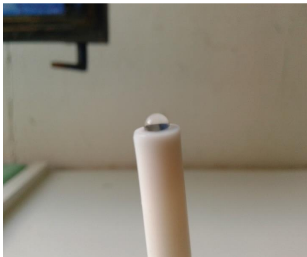
Figure IV.18 : Le dépôt de la membrane sur la surface de GCE
