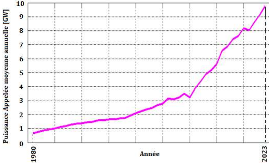
Figure 2.12: Evolution de la puissance appelée moyenne annuelle pendant les quatre décennies écoulées
