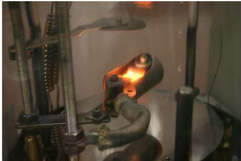
Figure III. 3 : Chauffage par effet Joule du creuset dans la chambre de dépôt.
