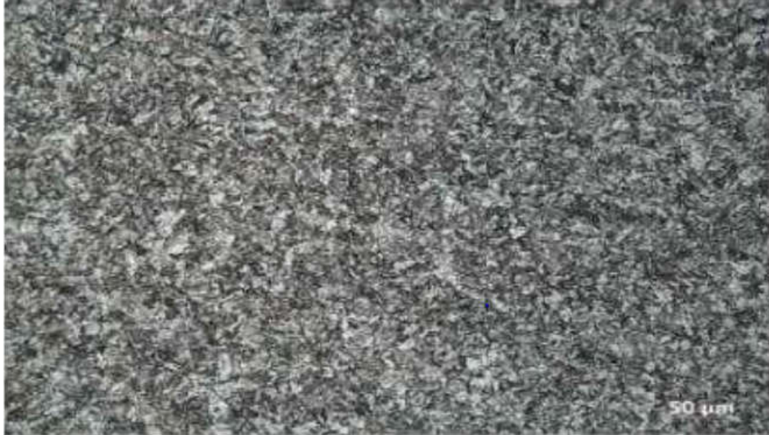
Figure I.11: Structure d'un acier inoxydable martensitique [23].
