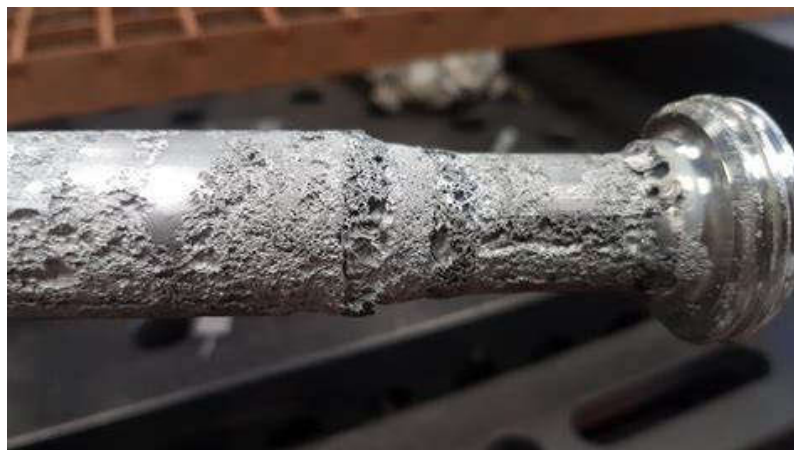
Figure I.5 : la corrosion caverneuse
