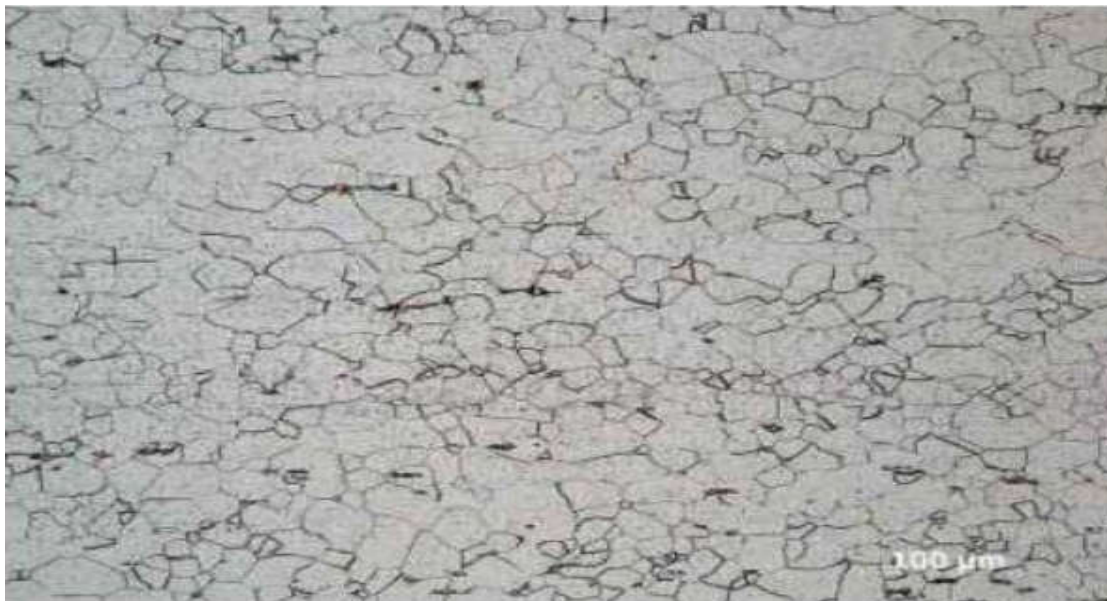
Figure I.10: Structure d'un acier inoxydable ferritique [23].
