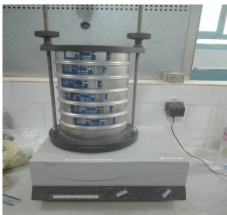
Figure II.4: Opération de tamisage avec une tamiseuse d'analyse (AS200 basic) [50].
