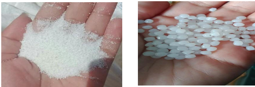
Figure II.1 : Photos représentatives du PEHD en poudre et en granulés.
