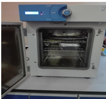
Figure II.3 : Séchage de PEA dans une étuve à 40°C [50].
