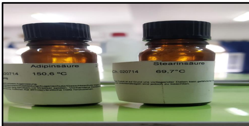
Figure 02 : Les témoins utilisés sur le banc Kofler
