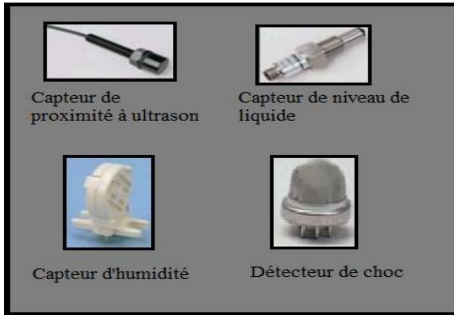
Figure I.4. Schéma représentant quelques types de capteurs.
