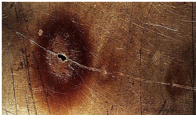
Figure II.15 : Effet d'une corrosion par piqûre.
