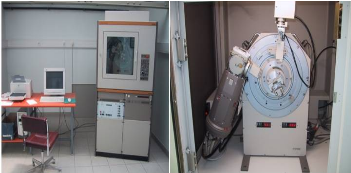
Figure II.20 : Photographie du diffractomètre automatisé de type SiemensD500 [14].
