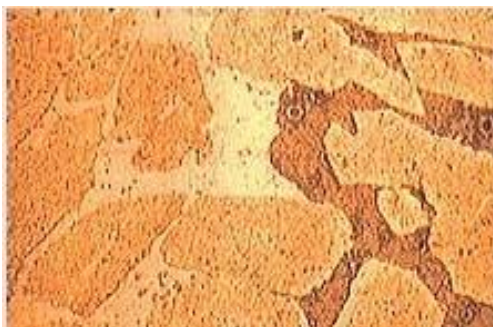
Figure I.12 : Coupe métallographique montrant une corrosion sélective d'un laiton [33].
