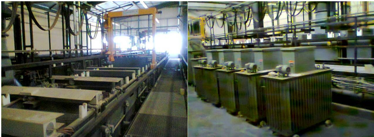
Figure I. 4: Les bains de décapage des laitons avec des doseurs de concentration d'acide sulfurique.
