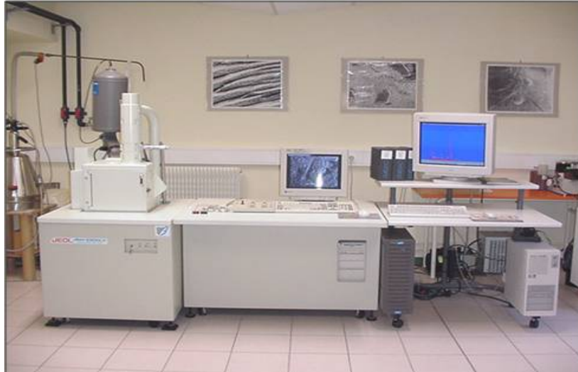
Figure II.17: Photographie du microscope électronique à balayage Philips ESEM XL30 [03].
