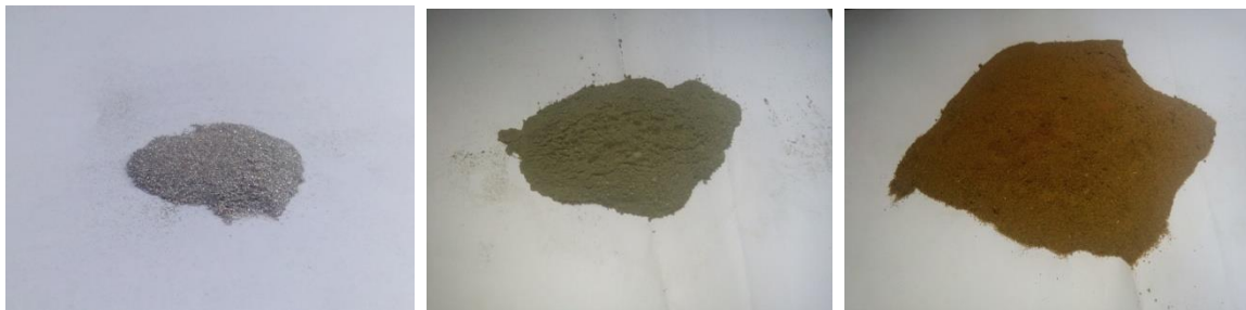
Fig (III.1). Les composants de mélange (Zinc, ciment, sable)
