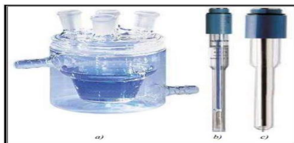
Fig (III.7). (a) Cellule de mesure, (b) électrode de référence, (c) contre électrode.
