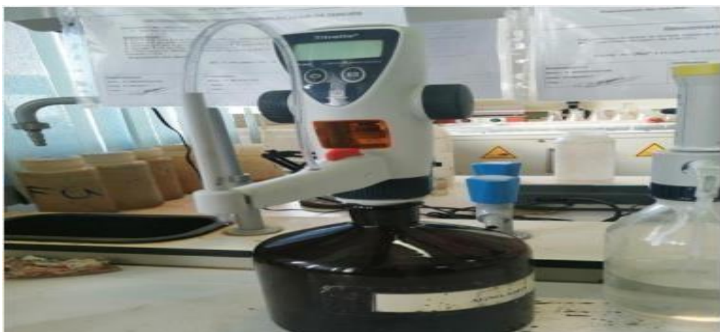
Figure. III. 3 : Appareille de titrage de chlorure.
