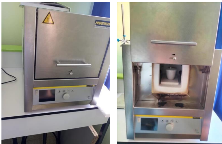
Figure IV.12 : Le four de carbonisation.
