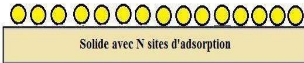
Figure II.3 : Modèle d'adsorption en monocouche selon Langmuir [59].
