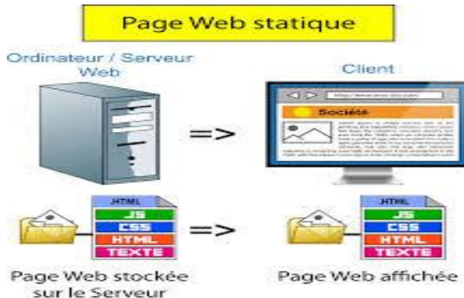
Figure 13 : Architecture des pages web statiques
