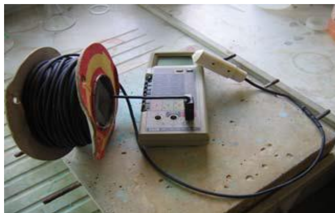
Figure III.13. Mesures de potentiels électrochimiques.
