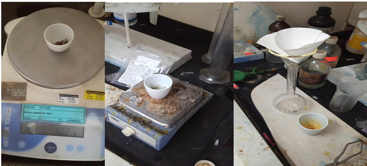
Figure 9:Blance digitale .Figure 10:Appareil de chauffage. Figure 11: Etape de filtration.
