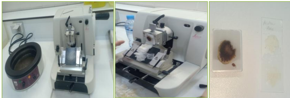
Figure 41: Microtome rotatif et Bain-marie de Type Leica RM 2125 RTS.
