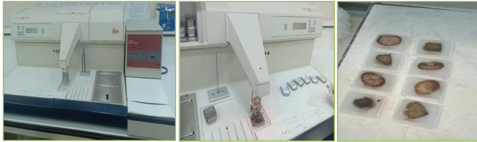
Figure 40: Station d'enrobage de type Lieca EG1160.
