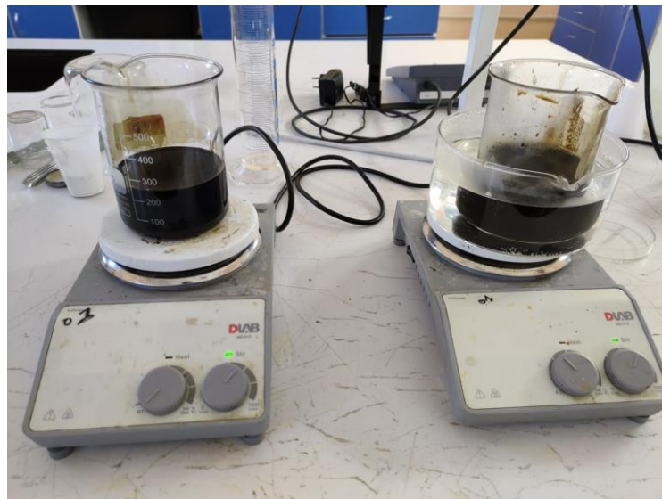
Figure III.9 : Agitation de l'huile usée avec les peaux de grenade à 25° C et 70 °C.
