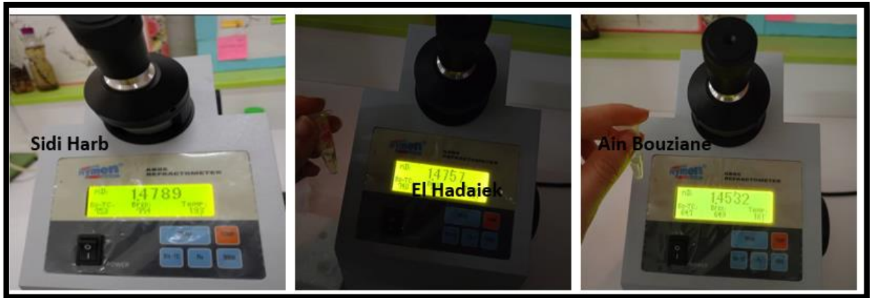
Figure 13 : Variation des valeurs de l'indice de réfraction sur le réfractomètre (prise personnelle le 12/03/2024).
