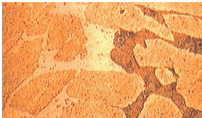
Figure. I.13: piqûres de corrosion typique de: [18]
