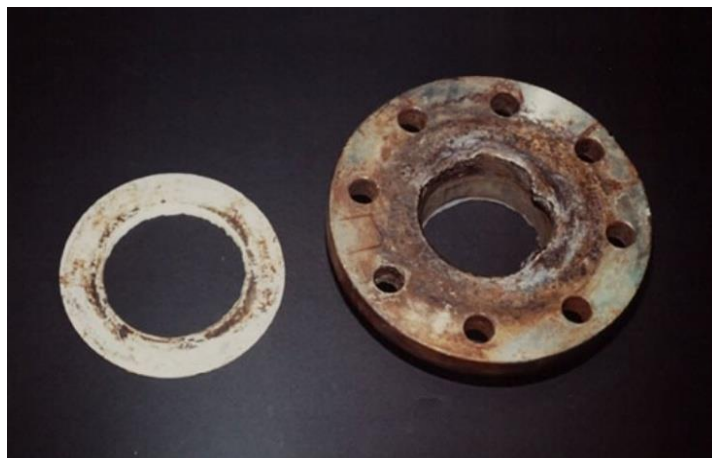
Figure. I.11 : La corrosion cavernieuse [16].
