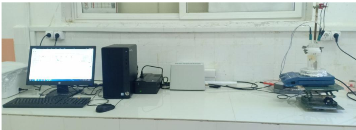
Figure III.6 : Schéma représentatif de la chaîne électrochimique de mesure
